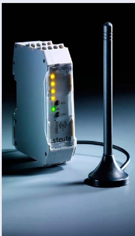
Die Wireless-Ex-Schaltgeräte funken aus dem Ex-Bereich hinaus und senden Signale an Repeatuer oder Empfangseinheiten, die im Schaltschrank untergebracht werden können
