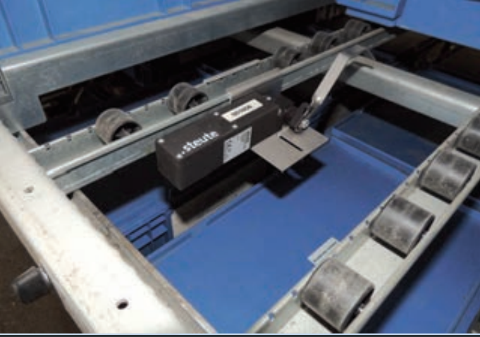
Funk-Positionsschalter von Steute melden, wenn ein Behälter aus den Regalen entnommen wurde.
