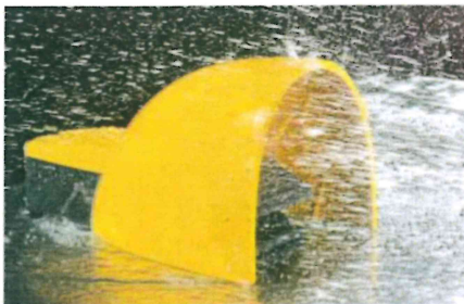
Sinnvoll, aber nicht zu 100% aussagekräftig bei Extrem-Einsätzen von Schaltgeräten: Korrosionsprüfung im Labor
