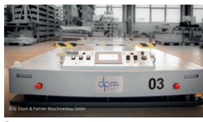
Über die sWave.net-Technologie werden FTS innerhalb kurzer Zeit aus dem Deep Sleep-Modus aufgeweckt.
