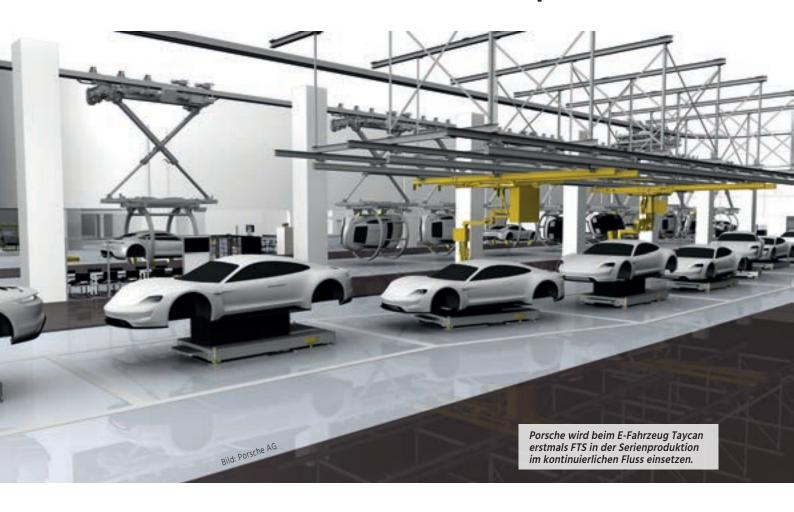
Neue Produktionskonzepte haben zum Ziel, eine flexible und hoch automatisierte Fertigung in Losgröße Eins zu ermöglichen. In der Automobilindustrie werden solche Konzepte, bei denen FTS im Mittelpunkt stehen, z.B. bei Porsche schon erprobt. Das erfordert eine flexible Kommunikation auf Shopfloor-Ebene – per Funk im Netzwerk.
