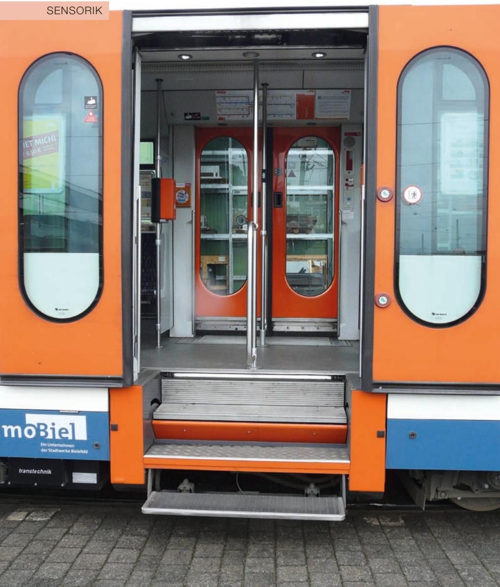
Ausgefallene Positionsschalter in der Trittstufenüberwachung an einer Stadtbahn-Baureihe in Bielefeld erhöhten den Wartungsaufwand. Der Betreiber MoBiel suchte nach einer Alternativlösung – und wurde ganz in der Nähe fündig. Nach einem erfolgreichen Test werden die Bahnen jetzt sukzessive mit langlebigen Positionsschaltern ausgestattet.
