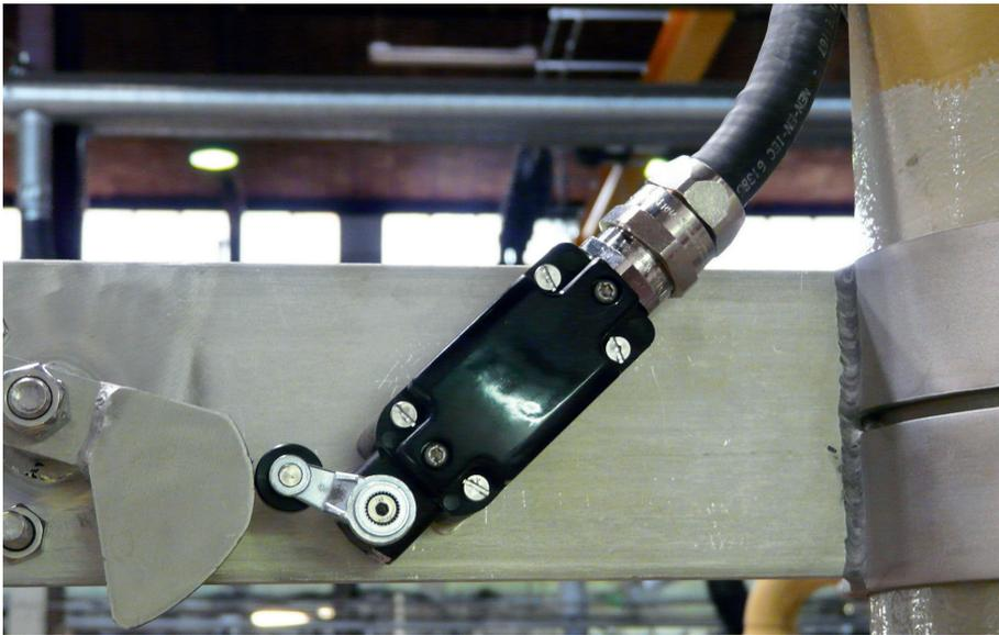
Die Stellung des Verladearms wird über „Extreme“-Positionsschalter von Steute abgefragt.
