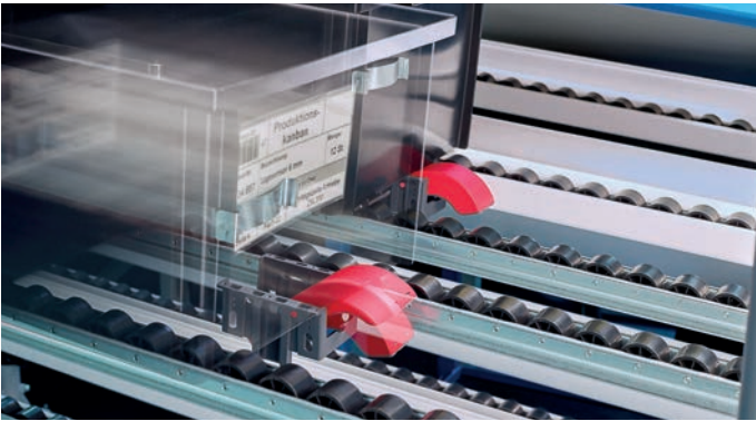
Funksensoren detektieren die Regalplatzbelegung und melden diese über die Funk-Infrastruktur an das Lagerverwaltungssystem
