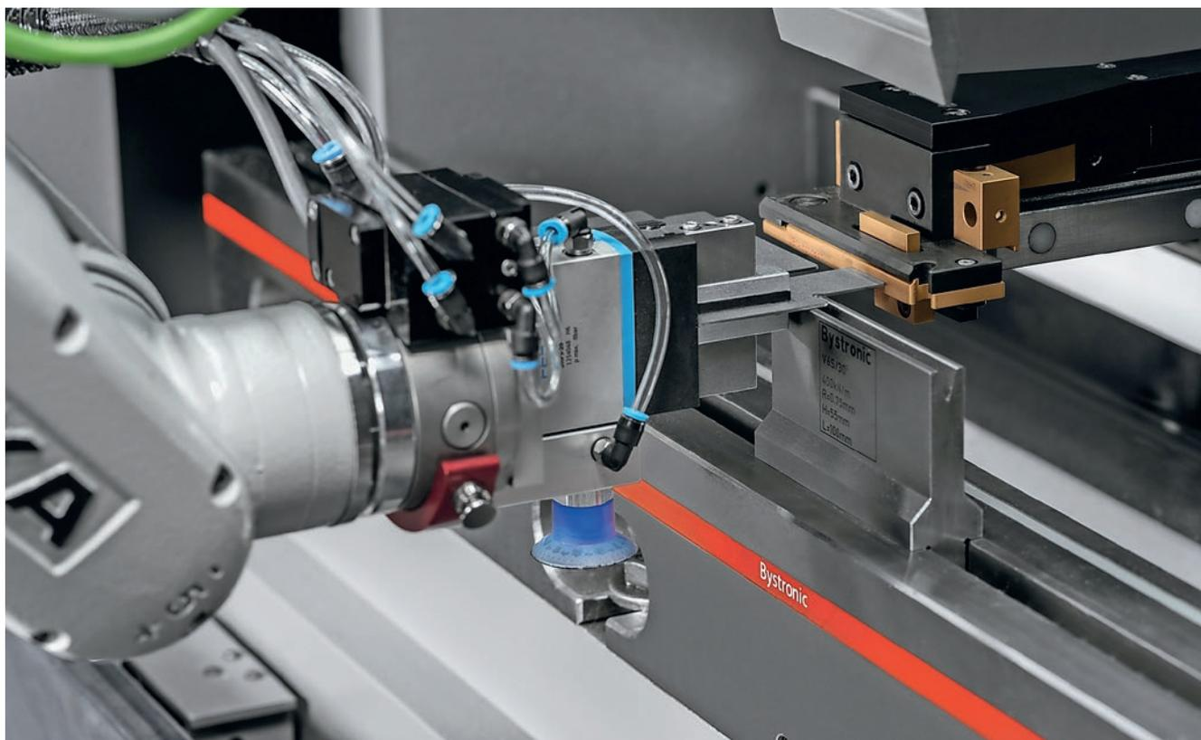
So werden Biegeprozesse noch flexibler: Ein Mikroschalter ermittelt, ob der Anschlag erreicht ist, und meldet die Information per Funk an die Automatisierungseinheit.
