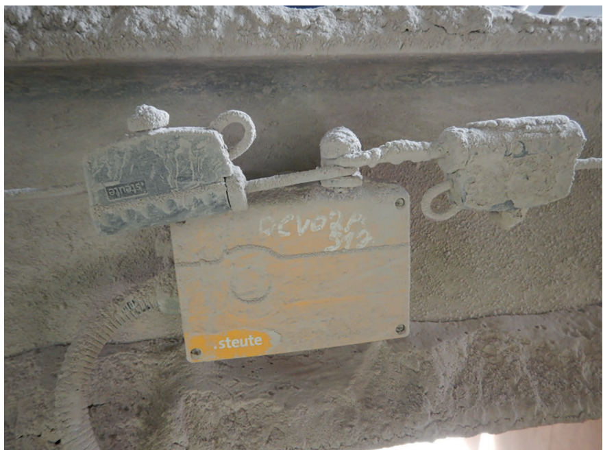
Bild 1 Seilzug-Notschalter müssen – wie dieses Einsatzbild zeigt – auch unter ungünstigen Umgebungsbedingungen zuverlässig arbeiten. Foto: Steute Technologies GmbH & Co. KG
