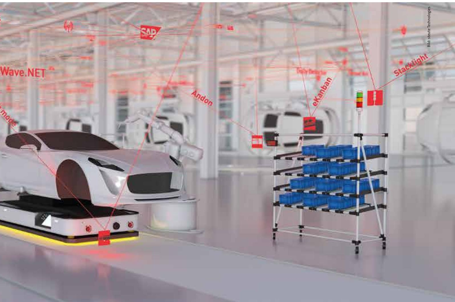
Access Points leiten die Funk-signale in der Montage oder in der Produktion an eine Sensor Bridge weiter. Diese bildet die Schnittstelle zum ERP-System.
