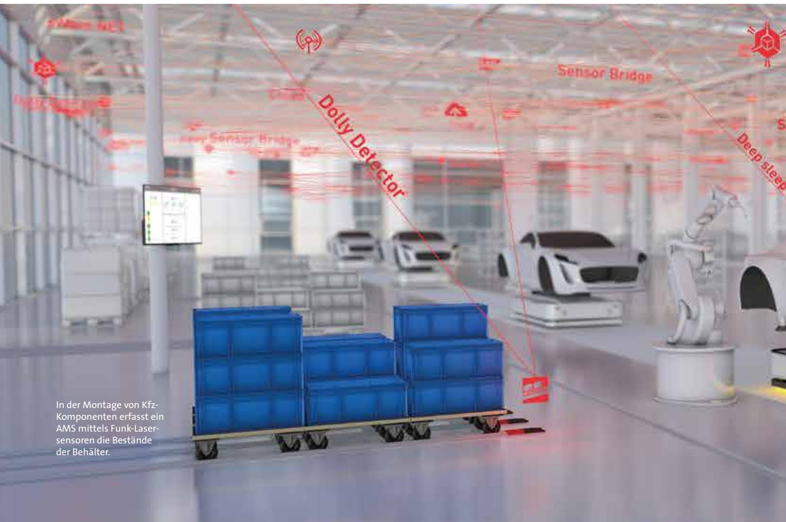
In der Montage von Kfz-Komponenten erfasst ein AMS mittels Funk-Lasersensoren die Bestände der Behälter.
