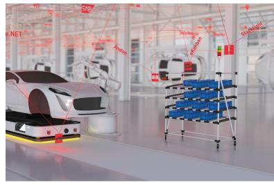
Flexibler und nahtloser Materialabruf: Das Funknetzwerk kann z.B. mobile eKanban-Regale in die Bestandsführung integrieren.
