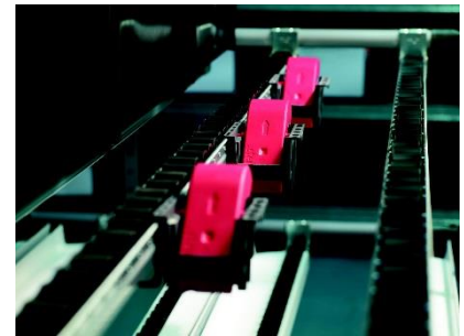
Sur les convoyeurs rapides, plusieurs capteurs radios positionnés en série, pilotent les besoins en matières, par exemple sur des postes d'assemblage.
