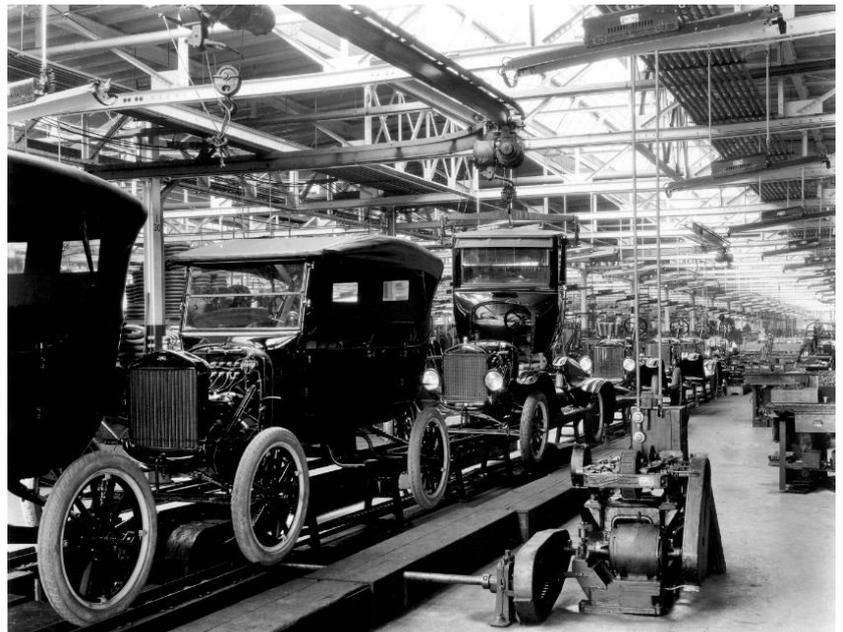
**Fig 1** Ford introdusse la produzione di massa con trasportatori fissi nel 1918. Attualmente molti produttori del settore automobilistico all'avanguardia stanno installando AGV più flessibili all'interno dei loro processi di assemblaggio.
