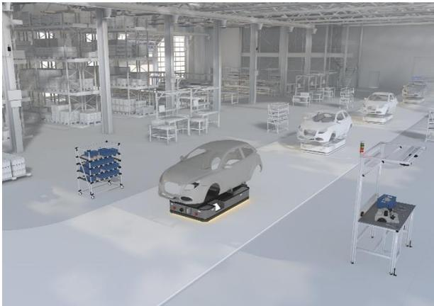
**Fig 2** In stabilimenti pilota, le case automobilistiche stanno testando la produzione seriale flessibile senza trasportatori stazionari, utilizzando veicoli a guida automatica.
