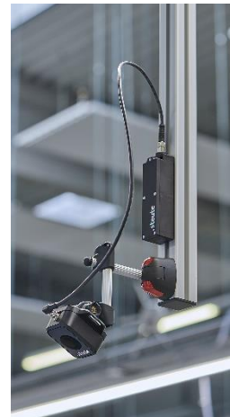
Vista dall'alto: i sensori laser rilevano e segnalano la presenza di pallet e contenitori, ma anche il livello di riempimento, ad esempio nei grandi vettori di carico (LLC).
