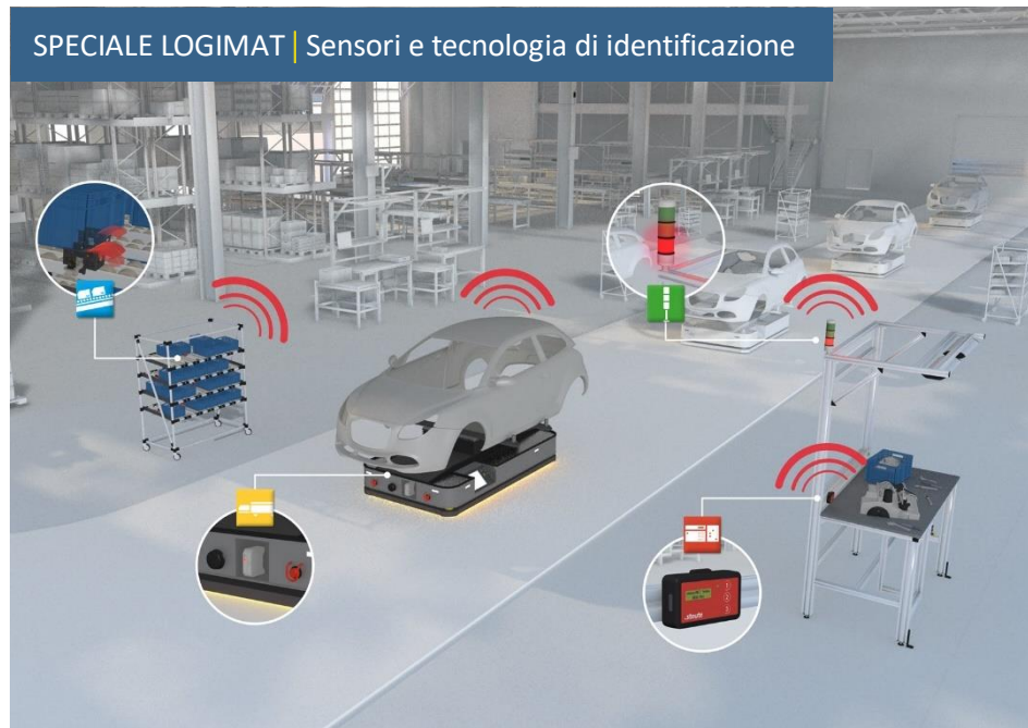
Vista dall'alto: i sensori laser rilevano e segnalano la presenza di pallet e contenitori, ma anche il livello di riempimento, ad esempio nei grandi vettori di carico (LLC).
