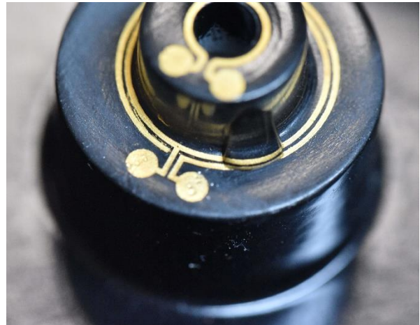
Due tracce conduttive stampate parallele facilitano la misurazione resistiva dell'umidità
