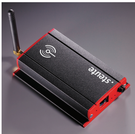
Rys. 2. Punkty dostępowe odbierają sygnały radiowe z pojedynczych czujników i przesyłają je przez WiFi lub sieć Ethernet do infrastruktury IT użytkownika.
