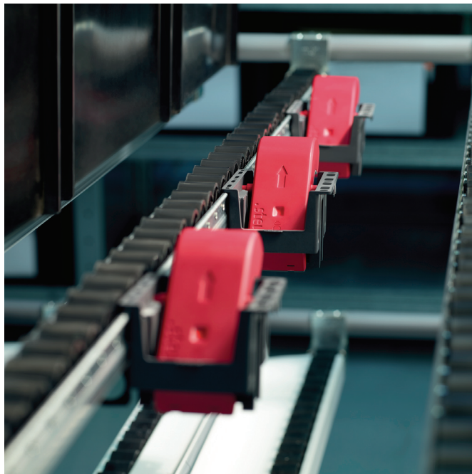
Rys. 5. W przypadku części szybko rotujących zamontowanie kilku bezprzewodowych czujników w rzędzie umożliwia odpowiednią kontrolę uzupełniania zasobników, na przykład na stanowiskach montażowych.
